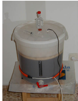
C) Conexión de la sonda de temperatura del termostato al fermentador
